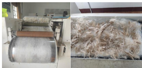
Fig. 3. Flax fibre web formation
