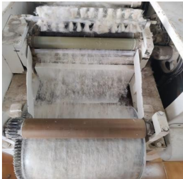
Fig. 4. Glass fibre web formation
