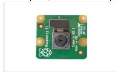
Fig. 3. Pi Camera Module
