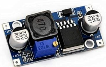
Fig. 8. LM2596 step down module
